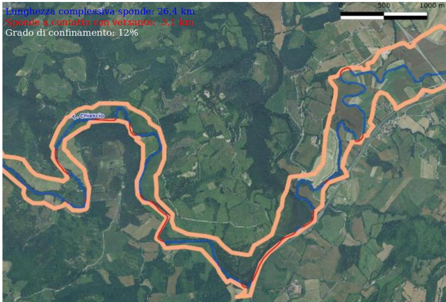
Fig. 9 - Calcolo del grado di confinamento tramite l'operazione di buffering + intersezione tra limite della pianura e sponde dell'alveo pieno.
