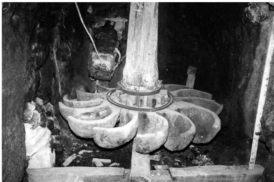
Fig. 10 - Particolare del mulino di Piedicava, il ritrecine (foto A. Melelli).
