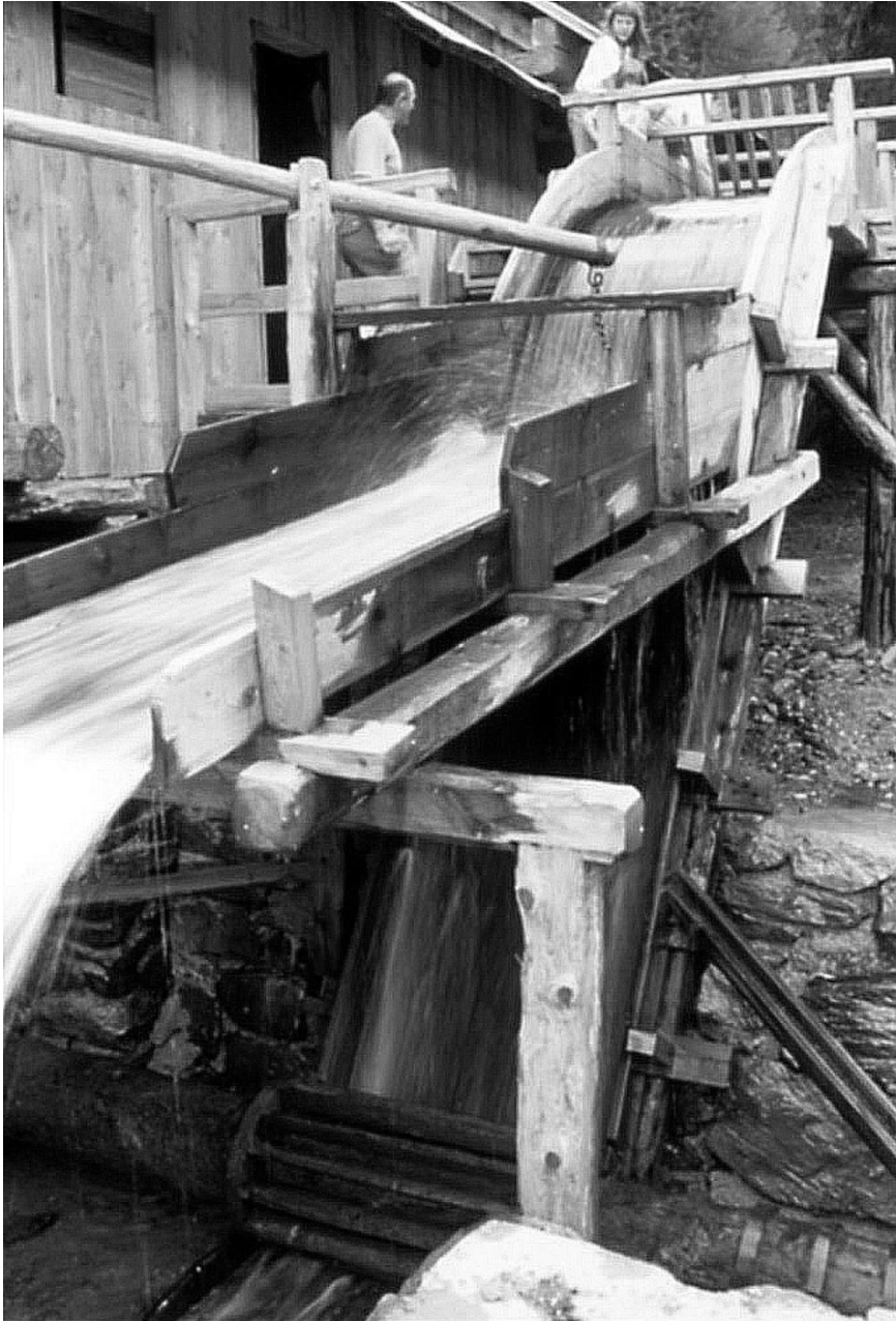
Fig. 15 – Uno dei sempre più numerosi casi di musealizzazione degli opifici idraulici, per lo più mulini da grano e da olio. Qui invece è una segheria, in Val di Rabbi, azionata da ruota idraulica verticale, la cui visita consente di apprezzarne l'ingegnoso impianto di funzionamento (foto A. Melelli).
