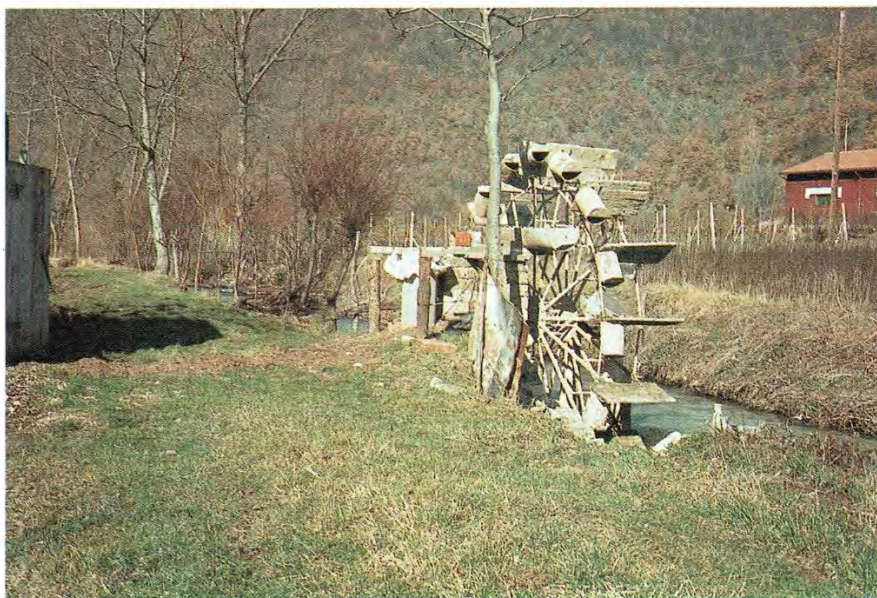
Foto 14 – Lu rotone , l'ultimo esemplare di ruota idraulica per l'irrigazione dei campi. È nei pressi di Scopoli, lungo la valle del Menotre.
