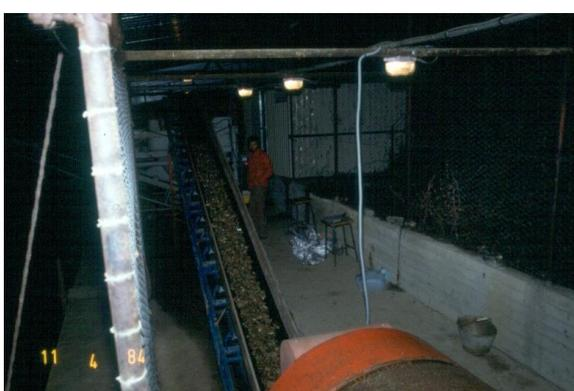
Fig. 9 – Dettaglio del vortex tube in funzione (a sinistra) e del nastro trasportatore verso cui è convogliato il materiale solido in uscita dal tubo. Foto: Paolo Tacconi.
