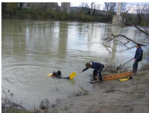
Fig. 4 – A sinistra: carotiere manuale a martello. A destra: prelievo subacqueo di un campione granulometrico di ghiaie e ciottoli. Foto: Andrea Fredduzzi. In: Cencetti et alii, 2015.
