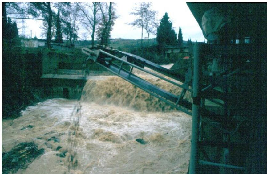
Fig. 11 – Dalla tramoggia il materiale viene caricato su un altro nastro trasportatore che reimmette i sedimenti a valle della stazione di misura. Foto: Paolo Tacconi.
