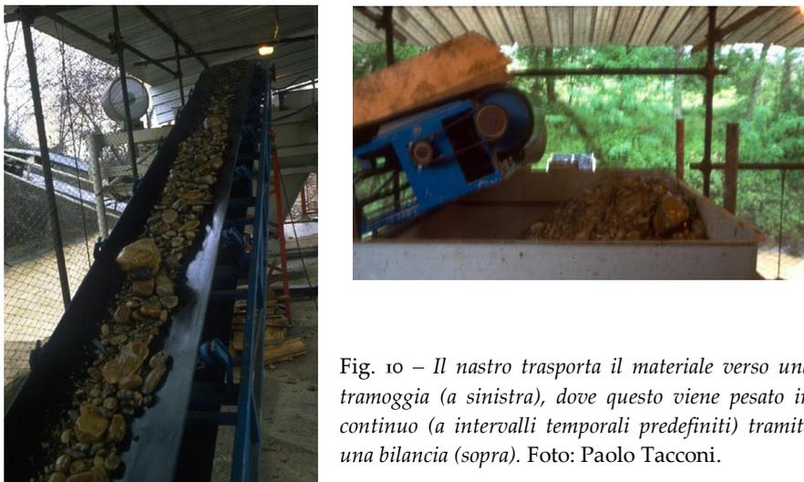
Fig. 10 – Il nastro trasporta il materiale verso una tramoggia (a sinistra), dove questo viene pesato in continuo (a intervalli temporali predefiniti) tramite una bilancia (sopra). Foto: Paolo Tacconi.
