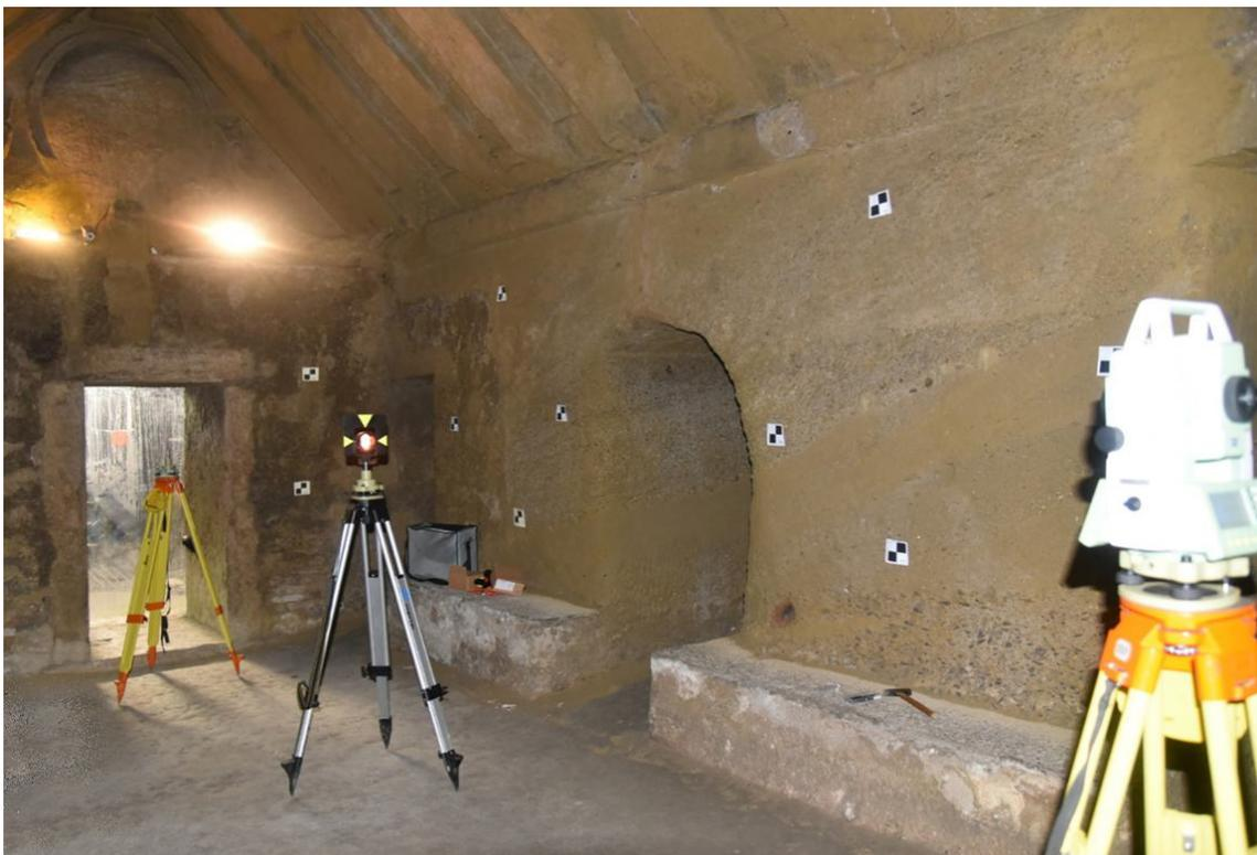
**Figura 9.** Misure con stazione totale all'interno dell'Ipogeo dei Volumni
