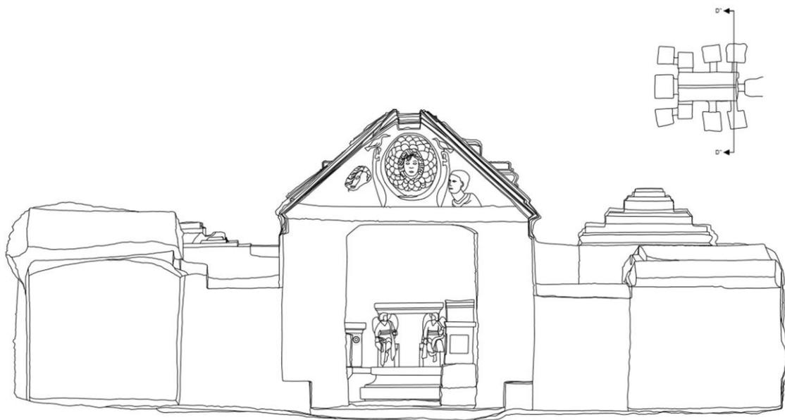
Figura 11. Sezione trasversale dell’Ipogeo dei Volumni
