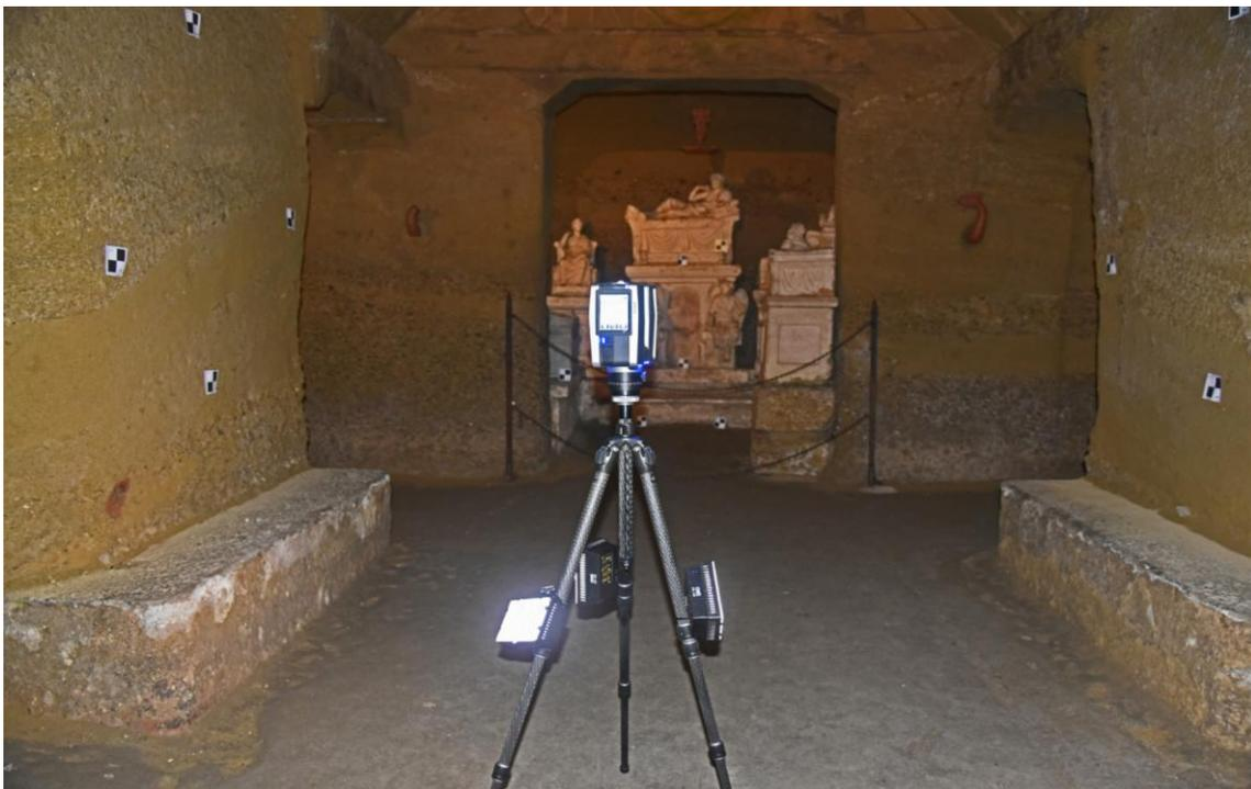
**Figura 1.** Esecuzione di una scansione all'interno dell'Ipogeo dei Volumni con laser scanner FARO X130
