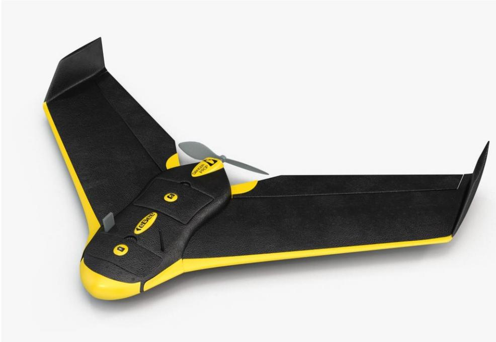
**Figura 6.** Drone ad ala fissa eBee SenseFly
