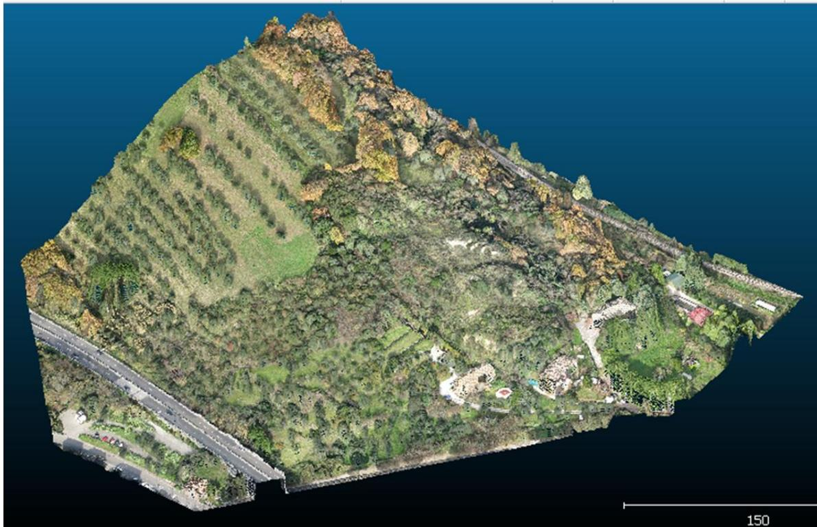
**Figura 9.** Ortofotocarta sul modello digitale delle superfici (DSM) dell'area della Necropoli
