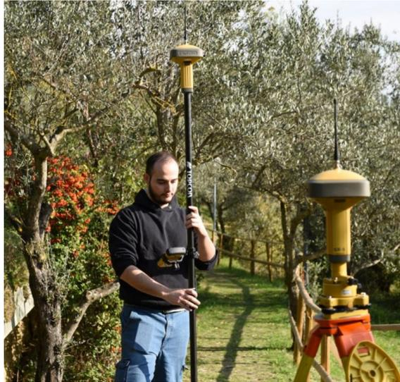
**Figura 3.** Misure in modalità RTK base-rover nella Necropoli del Palazzone
